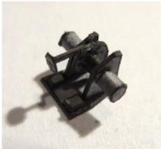
Grundplatte 15a aufkleben. Auf Teile 15b und 15c kleine Scheiben aufkleben. Trommel 15d rollen und auf 15c über die kleine Scheibe kleben. Ankerwinde ausrichten und kleben. Trommeln 15e herstellen und außen über die Scheiben der Seitenteile kleben. Stange 15f zwischen Seitenteil und Trommel kleben, Handrad ankleben. Kettenstopper 15g vor der Ankerwinde anbringen.
