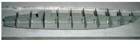
einem der mittleren Spanten festkleben. Die weiteren Spanten jeweils zum Bug und Heck abwechselnd einkleben. Die be-
