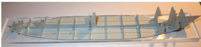
Die Spanten von der Mitte aus jeweils zum Bug und Heck abwechselnd einkleben. Die bedruckte Seite der Spanten zeigt zum Heck.
