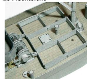
Nur bei ziviler Version, optional. Die Fischteiche dienen der Vorsortierung des mit dem Netz über die Reling gehievten Fangs. Schlitzte einschneiden und Teile zusammenkleben. Zwischen Seilwinde und Mast aufkleben.
