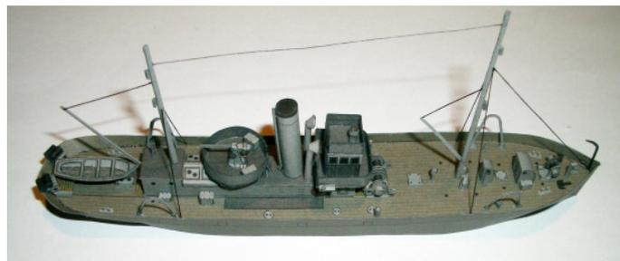
Spätere Version/WK2: Kanonenplattform mit 12pdr Kanone am Bug, Kanonenplattform mittschiffs mit zwei Zwillings-MGs, Beiboot auf einem Gestell steuerbord vor dem Ruderhaus, daher mehr Platz im Heckbereich für Wasserbomben.
